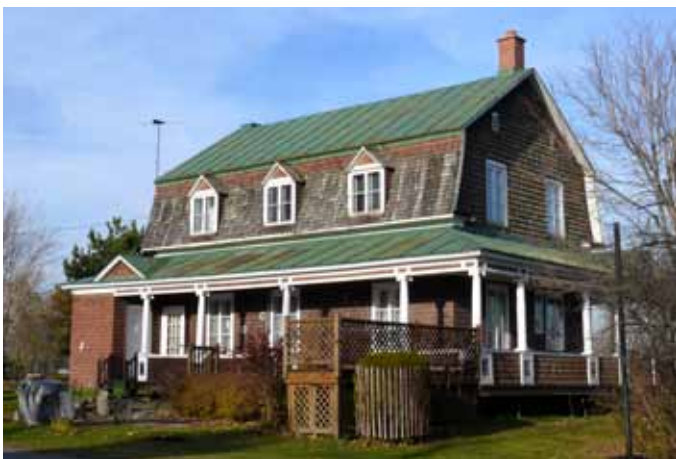
Trois lucarnes à pignon sur une maison sise au 531, route 153 à Saint-Tite.
